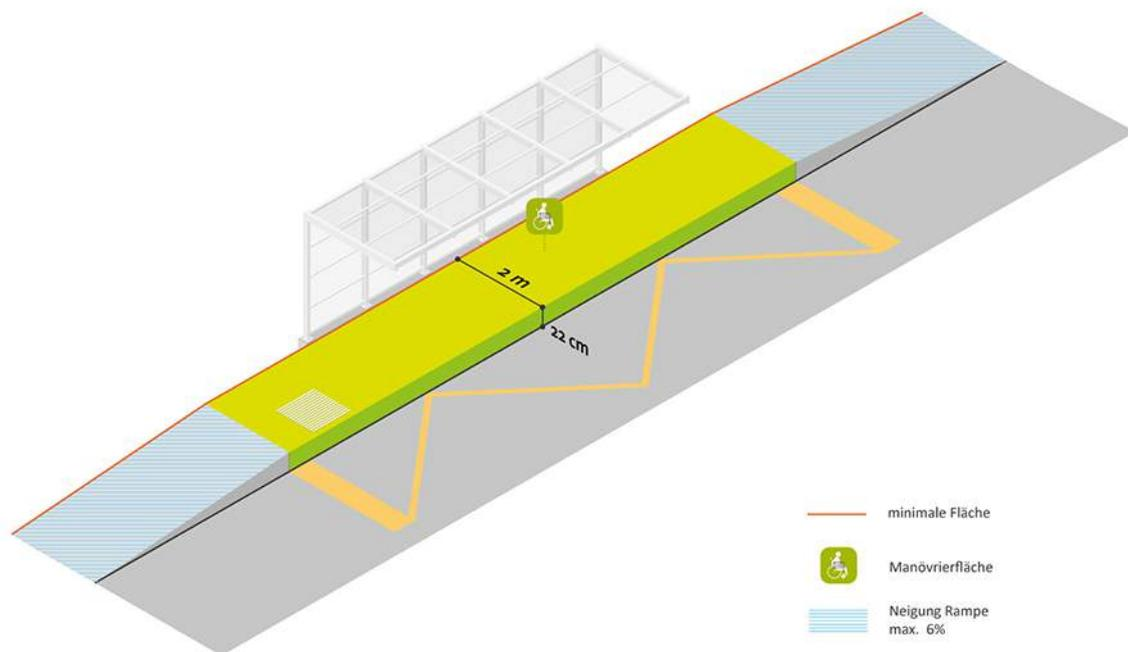
**Abbildung 1: Schema Baulicher Standard für hindernisfreie Bushaltestellen**
