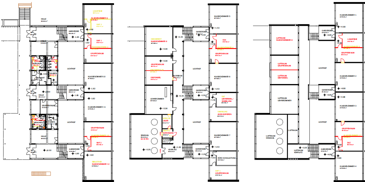
Grundrissanpassungen (rot) im bestehend Schultrakt Erdgeschoss, 1. und 2. Obergeschoss
